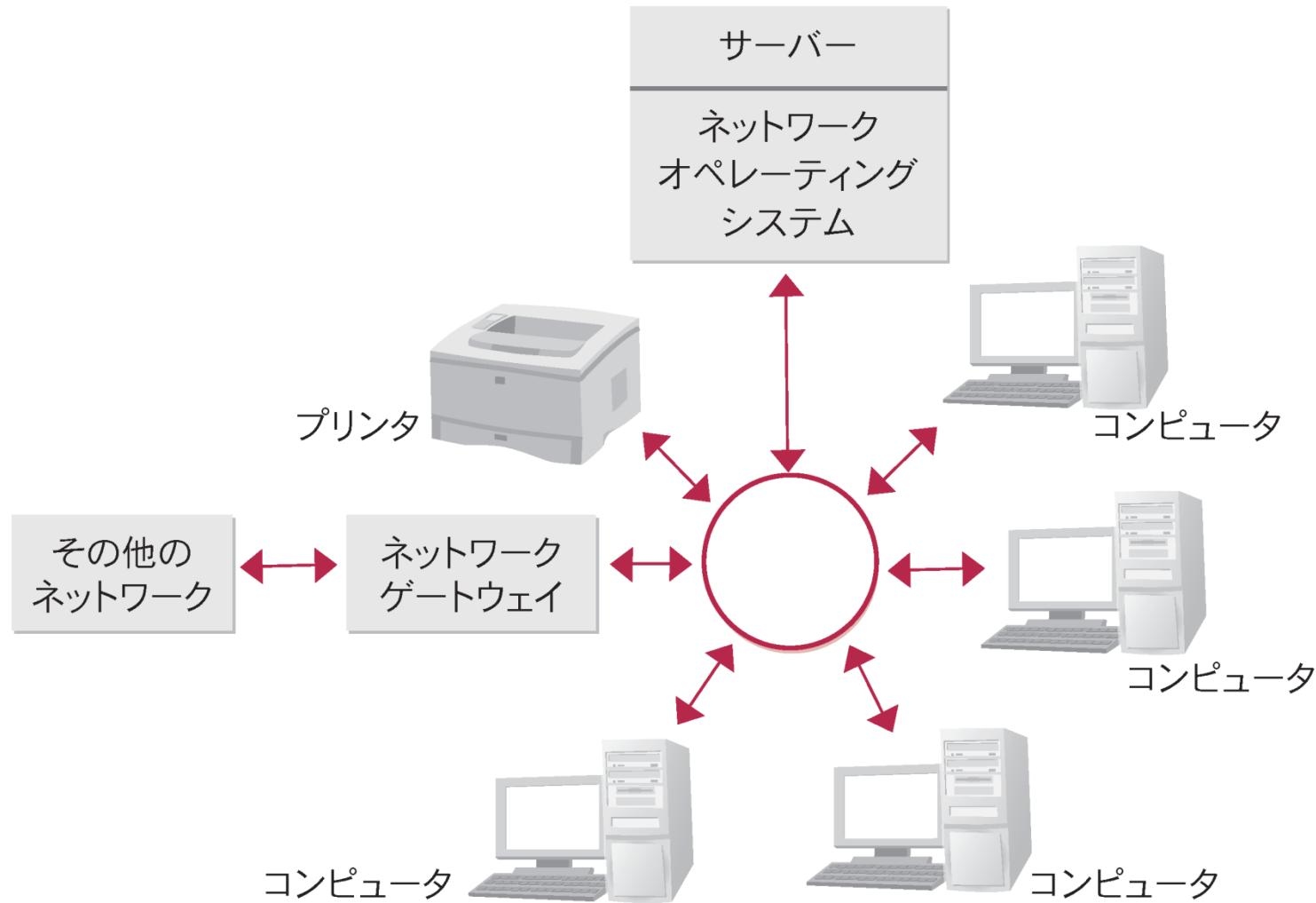
上の図は、LANの一モデルであるが、LANにより、電子メールの交換、ファイルの共有、プリンタの共有、及びデータベースの共有が簡単にできる。サーバーは、データファイルやプログラムを保存しそれらをネットワーク利用者のために提供する。また、ネットワークゲートウェイが、LANと公設データネットワークを接続することで外部のネットワークとの情報交換も可能になる。
