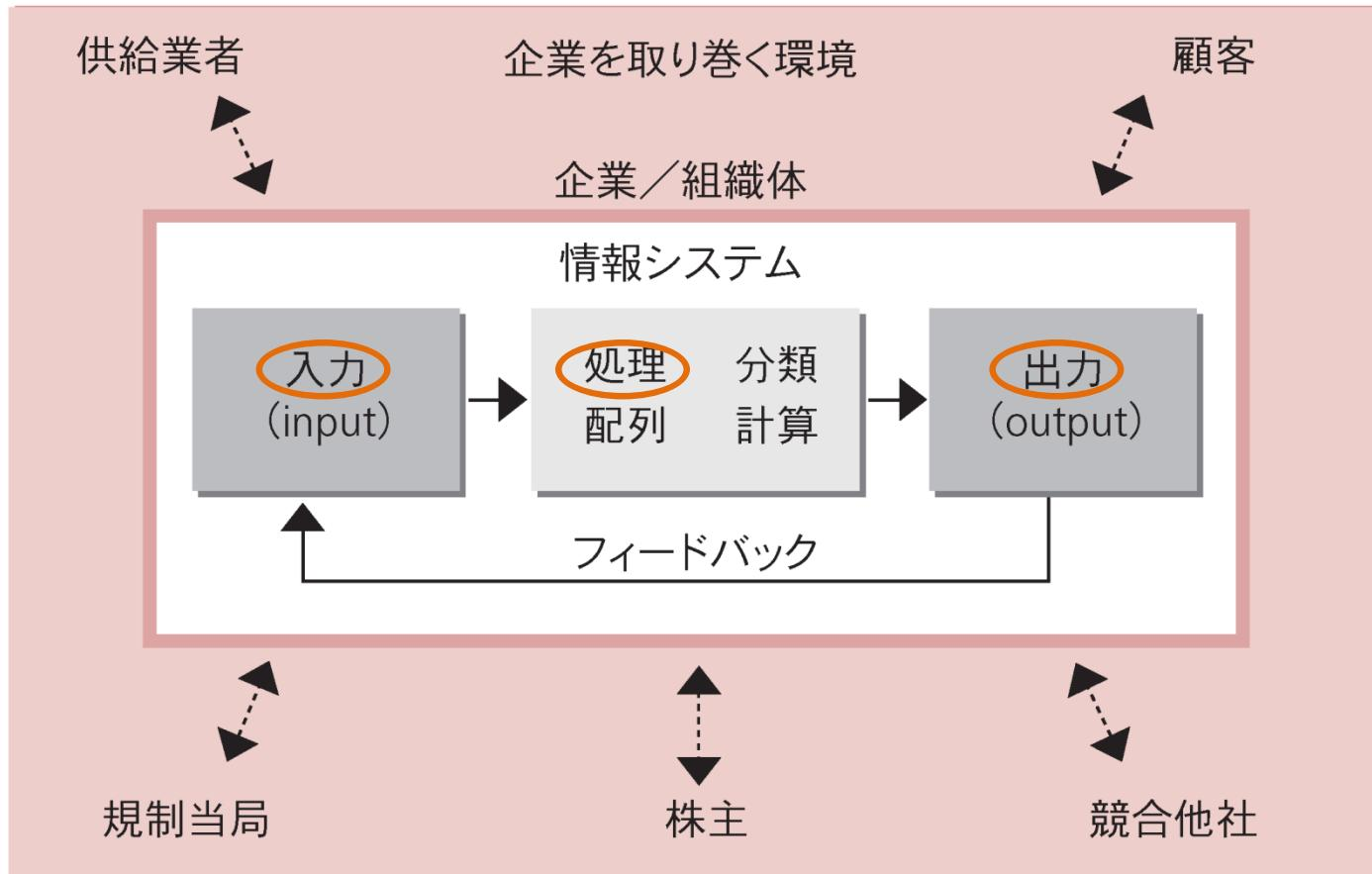
情報システムの3つの要素とは、入力、処理、及び出力である。入力では、組織内外より生のデータを収集し、処理では入力された生のデータをより意味のある形へ転換する。出力では、処理された情報を、利用者へ配信をすると共に、入力が正しかったかどうかを評価するためにフィードバックを行う。
